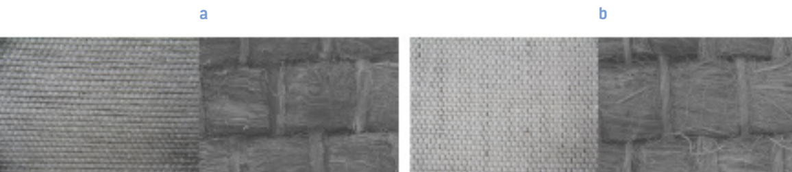
Rysunek 5. Tkaniny lniane o splocie płóciennym wytworzone z przędzy niskoskrętniej 68 tex (osnowa) oraz niedoprzędów naturalnego (a) i bielonego (b) o masie liniowej 2000 tex (wętek), oraz obrazy mikroskopowe tkanin wykonane przy pomocy elektronowego mikroskopu skaningowego SEM ze zmienną próżnią.
