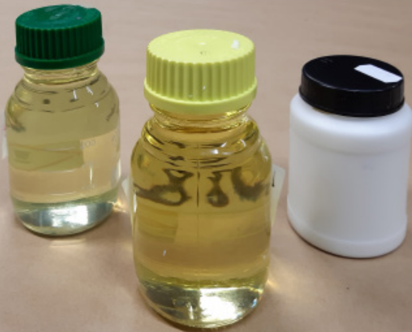
Rysunek 9. Żywica epoksydowa na bazie siemienia lnianego. W jej skład wchodzi: zmodyfikowany epoksyd, utwardzacz, środek uniepalniający.
