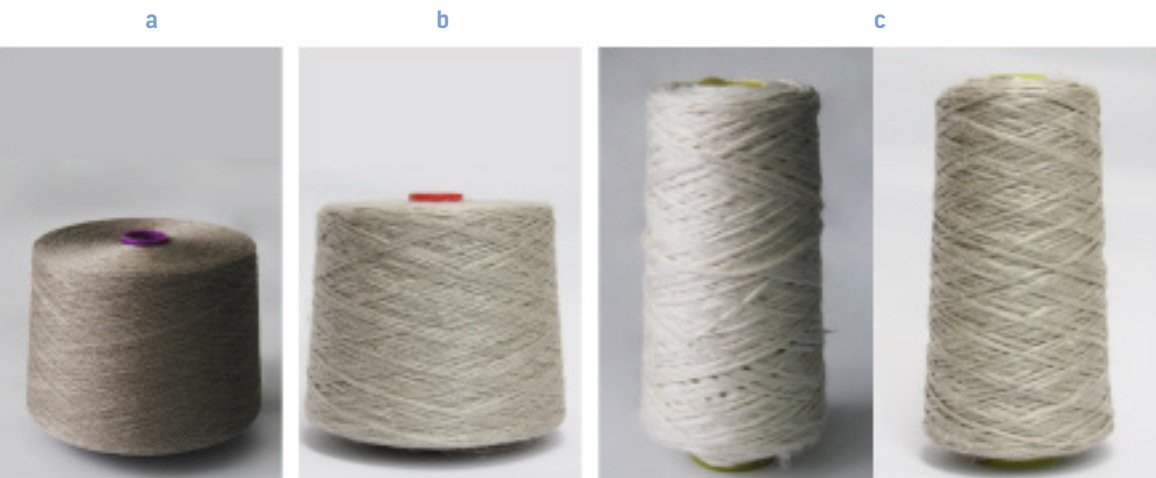
Rysunek 4. Przędza niskoskrętna o masie liniowej 68 tex (a) oraz niedoprzędę o masach liniowych: 400 tex (b) i 2000tex (c) naturalny i bielony.
