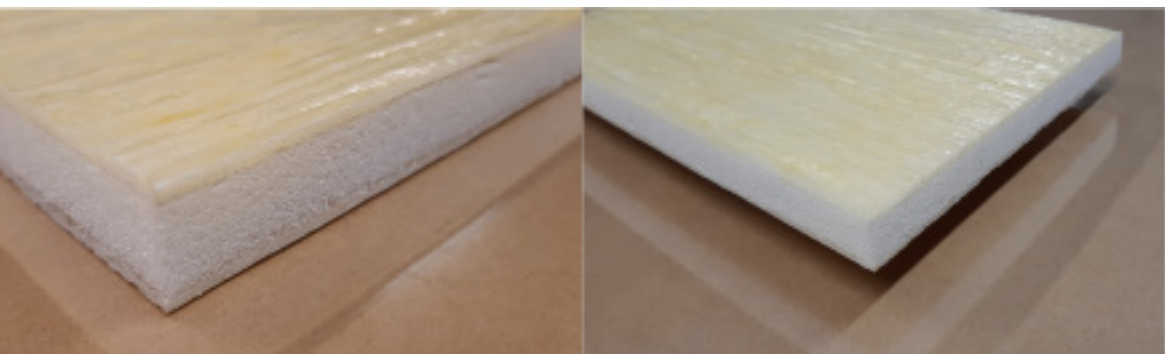
Rysunek 10. Konstrukcja typu sandwich z elementami zewnętrznymi wykonanymi z kompozytu na bazie bielonych włókien lnianych oraz żywicy epoksydowej na bazie oleju z siemienia lnianego.
