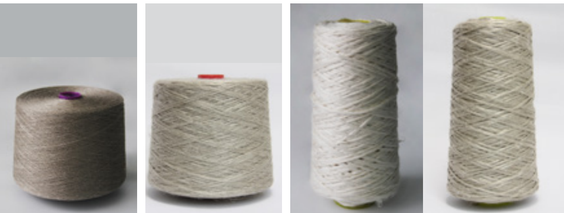
Rysunek 4. Przędza niskoskrętna o masie liniowej 68 tex (a) oraz niedoprzędę o masach liniowych: 400 tex (b) i 2000tex (c) naturalny i bielony.
