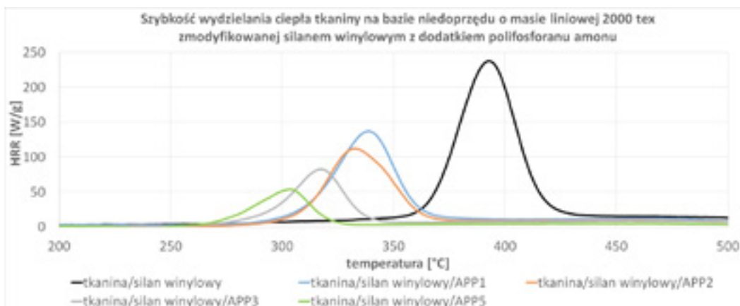
Rysunek 8. Krzywe szybkości wydzielania ciepła tkaniny na bazie niedoprzędu o masie liniowej 2000 tex zmodyfikowanej silanem winylowym z dodatkiem różnych ilości polifosforanu amonu.
